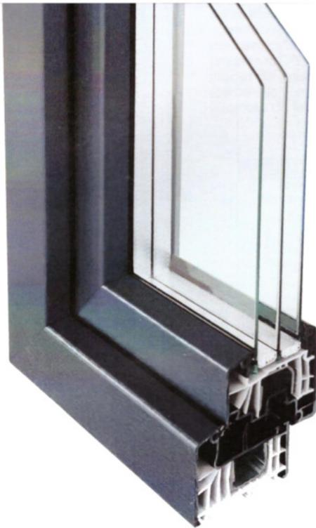
**INTERTEC 85 MD** Aluplast ist ein hochwertiges 6-Kammer-System mit einer Bautiefe von 85 mm und 3 Dichtungen. **INTERTEC 85MD** ist ein fortschrittliches Fensterprofilsystem, das dank der Umsetzung innovativer Lösungen hervorragende technische Parameter und einen hohen Komfort bei der Fensternutzung bietet.
