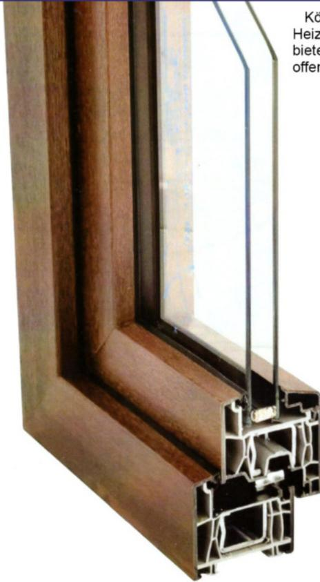
Kömmerling / Trocal 70 Ad ist ein 5-Kammer-System mit einer Bautiefe von 70 mm, das spürbare Heizkostensparnis, hohen Schallschutz, Einbruchschutz und vielfältige Gestaltungsmöglichkeiten bietet. In puncto Befestigungsmaterial lässt das System Kömmerling / Trocal 76 Ad keine Wünsche offen, so dass alte Fenster problemlos gegen neue ausgetauscht werden können.
